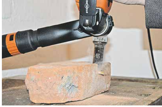
Nur mal als Beispiel: Selbst der Ziegelstein hat dem TiN-Blatt nichts entgegenzusetzen.
