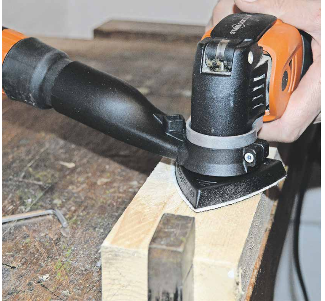
Eine neue Erfahrung: Der Staub landet auch beim Oszillierer jetzt in der Absaugung.
